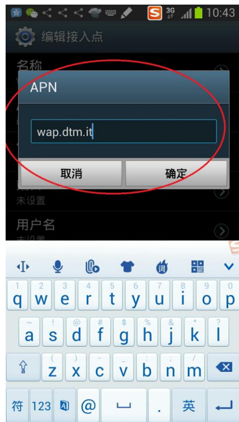
8. 将 mobile.vodafone.it 修改为 wap.dtm.it 后确认
